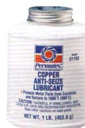
Antiderrapante y lubricante de cuerdas con base de cobre calidad Premium, puede ser utilizado para prevenir aferramiento, corrosión y abrasión en donde existan altas temperaturas. Contiene un alto porcentaje de micro hojuelas de cobre en una grasa semi-sintética y está fortificado con inhibidores de alta calidad de óxido y corrosión. Rango de temperatura -34°C a 982°C Proporciona una conductividad eléctrica buena.
