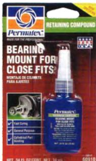
Adhesivo anaeróbico de baja viscosidad y curado rápido, que aumenta la fuerza de ensamblaje de ajuste con presión o ensamblaje por deslizamiento, de hasta 0.15 mm. de diámetro. Aumenta hasta 3000 PSI el poder de sujeción.
