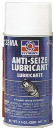
Mezcla de lubricantes de aluminio, cobre y lubricantes de grafito. se utiliza durante el ensamblaje, para evitar la corrosión y los derrapes debido al clima o a los químicos. El anti engripante, asegura un desmontaje fácil. Rango de temperatura -51°C a 871°C. Es resistente a la sal, a la corrosión y a la humedad. Es ideal para el uso marino.
