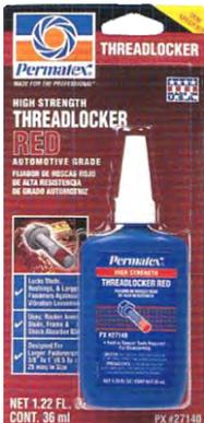
Fijador de alta resistencia para tareas de trabajo pesado de 10mm a 25mm. Especialmente diseñado para asegurar permanencia de pernos y equipos de presión. Tiene un poder de sujetamiento de 3000 PSI, reemplaza tornillos y seguros. Asegura contra la pérdida de vibración. Puede requerir calor o herramientas especiales para removerse
