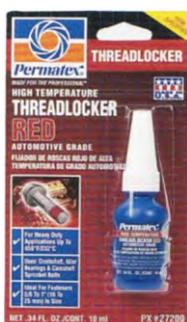
Sellador de alta temperatura y alta resistencia para aplicaciones de trabajo pesado. Previene que tornillos de 10 a 38 mm. se aflojen debido a vibración severa y calentamiento. Fórmula exclusiva para máquinas nuevas y de alto desempeño que requieren resistencia a temperaturas extremas. apropiado para temperaturas de hasta 232° C. Requiere calentamiento y herramientas de mano para removerse.
