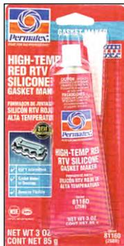
Formulado para aplicaciones con altas temperaturas, o de uso pesado. Reemplaza casi cualquier junta pre cortada. Con la tecnología confiable de "formar en el lugar" las juntas resisten el agrietamiento, estrechamiento y estiramiento más severos, causado por la variación térmica. Cubre las juntas pre-cortadas para aumentar la confiabilidad. Capaz de soportar temperaturas de -54°C a 343°C intermitentes, resistente a todo tipo de fluidos del taller y del automóvil.
