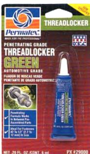
Fijador líquido de baja viscosidad que penetra alrededor de los hilos de los tornillos pre-ensamblados para fijarlo en el lugar. Para ser aplicado después del armado, los procedimientos de mantenimiento preventivo se simplifican. Ideal para tornillería de 2.2 a 12 mm. Se requiere calor y herramientas de mano para desensamblar.
